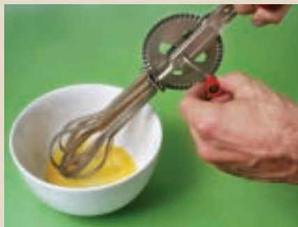
Batido mecanizado. Mediante un mecanismo de engranajes se transmite el movimiento generado a partir de la manivela.
