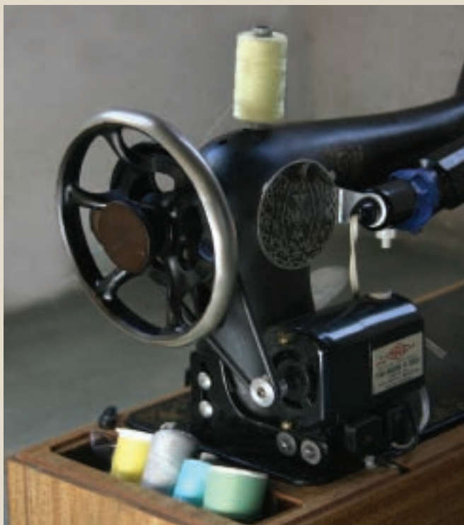
Las poleas transmiten movimientos de rotación.
