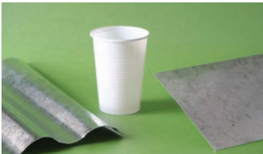
Es posible otorgar mayor rigidez a ciertos materiales doblándolos o plegándolos.
